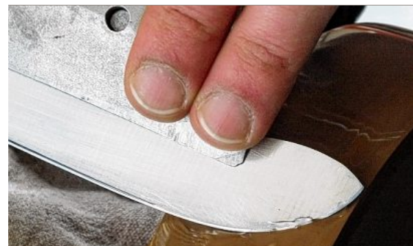
Während des Schleifens wird die Klinge mit Wasser gekühlt.
